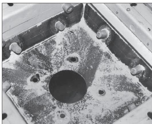
Connection to be welded 1" GAS, air inlet 1/2" GAS.
